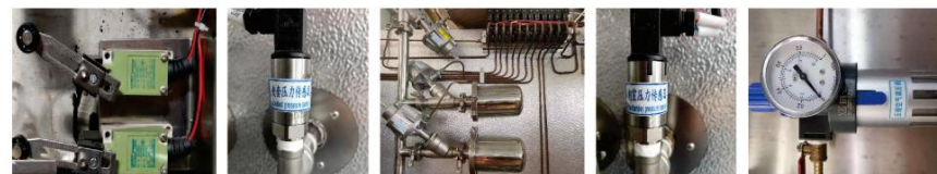
行程开关 夹套压力传感器 空气过滤器 内室压力传感器 压缩空气调压阀
